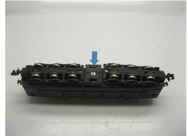
Montieren Sie die untere Schraube Mount the bottom screw Monteer de schroef in de bodem
