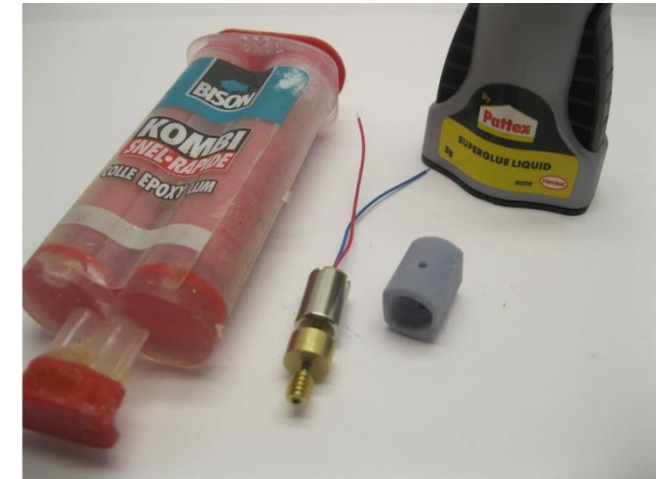
Der Motor wird mit Epoxidkleber oder Sekundenkleber in den Motorhalter eingeklebt The motor is glued into the motor holder with epoxy glue or super glue De motor wordt verlijmd in de motorhouder met secundelijm of epoxy lijm
