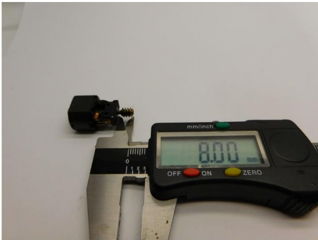
Maße prüfen Check dimensions Controleer de maatvoering
