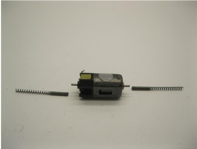
Entfernen Sie die Federn vorsichtig mit einer Pinzette Carefully remove the springs with tweezers Verwijder de veren voorzichtig met een pincet
