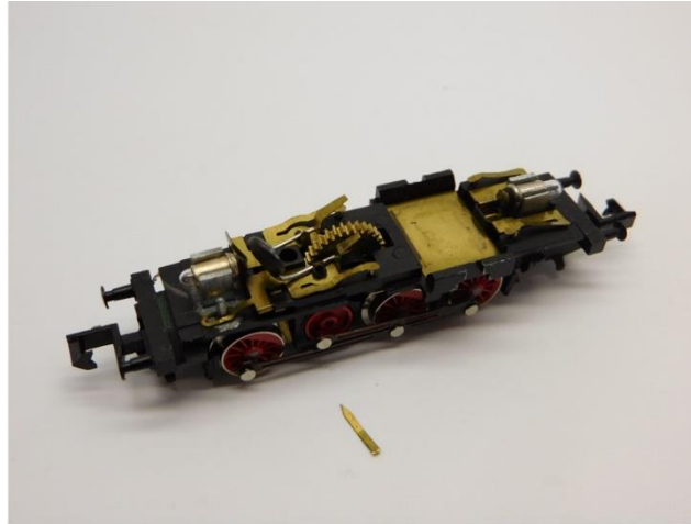
Die Kontakte müssen gekürzt werden The contacts must be shortened De contacten moeten ingekort worden
